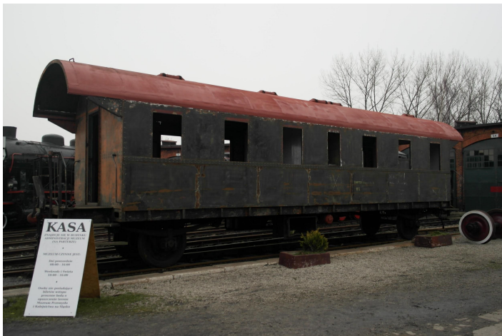
Wagon Ci28 w trakcie naprawy dachu i pudła
