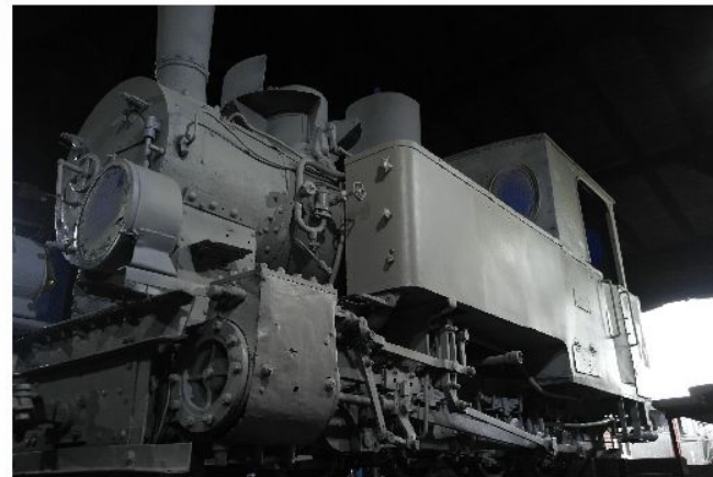
Widok parowozu po wykonaniu powłoki konserwującej
