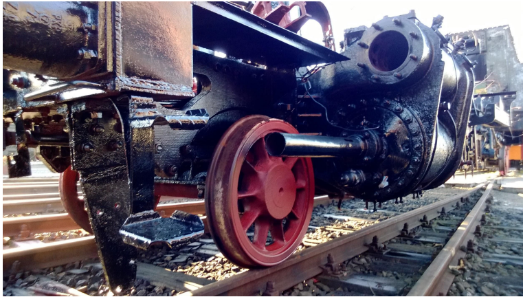
Widok zregenerowanej przedniej osi tocznej oraz cylindrów parowozu
