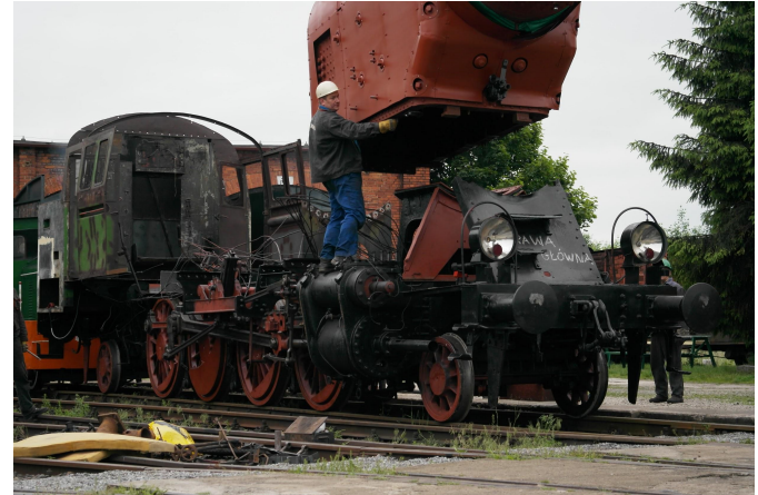
Montaż kotła po Naprawie Głównej w ramie
