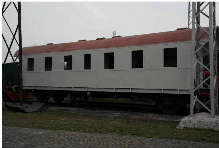
Wagon Ci28 pokryty powłoką konserwującą
