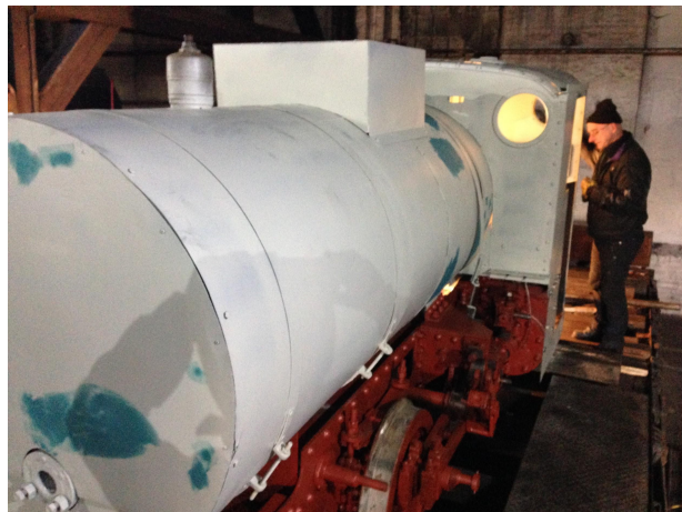
Wykonywanie nowych powłok konserwujących na lokomotywie BMAG
