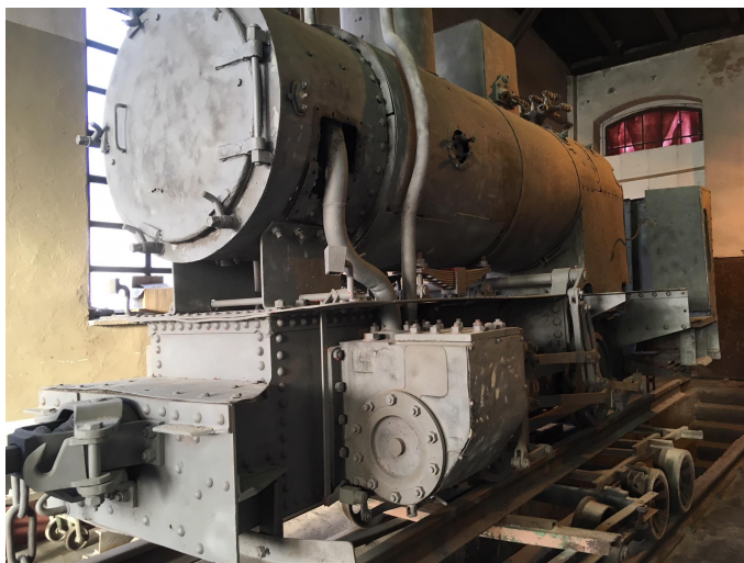
Kocioł i rama po wykonaniu powłok konserwujących
