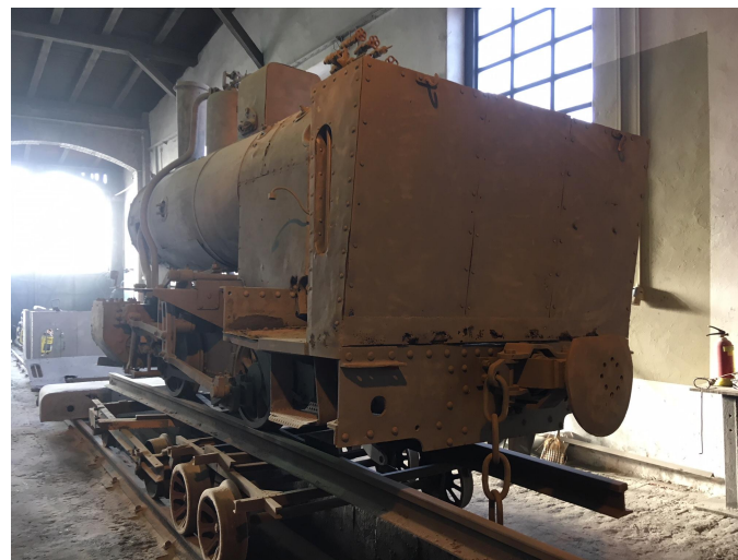
Lokomotywa po zdemontowaniu części poszycia, podczas oczyszczania
