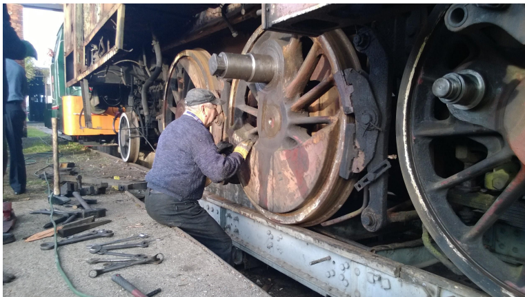
Demontaż osi parowozu na zapadni kolejowej
